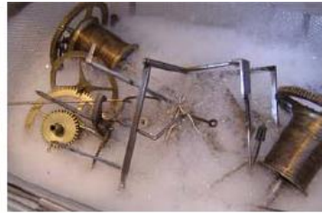
- Desmontaje de todos y cada uno de los elementos que componen el reloj, limpieza, reparaciones, ajustes, etc
