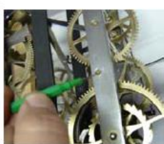
- Eliminación de óxidos, pulido, azulado, lubricado, reposición mecanismo calendario, reparación péndulo, suspensión, etc
